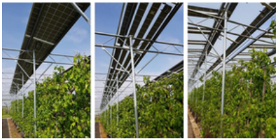
Perenbomen onder drie verschillende zonnepaneleninstallaties bij de proeflocatie in Randwijk. Foto: WUR
